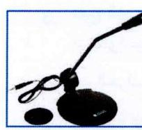
هو الأداة التي تتمكن المستخدم من تسجيل الصوت، وإدخاله إلى جهاز الحاسوب، كما يمكن تحويل هذه الأصوات إلى نصوص بشكل مباشر عن طريق برامج معينة مسؤولة عن عملية التحويل.
